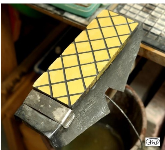
Fig. 41: Grooved honing stone (Cerax 6000)
